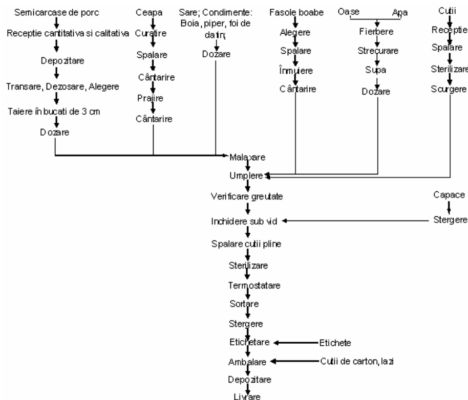
Figura 7.2. Schema tehnologică de fabricare a conservelor mixte de carne de porc și fasole boabe
