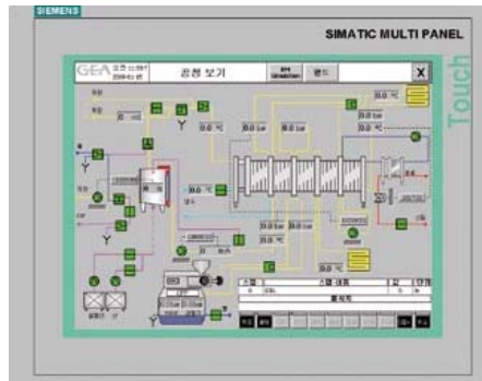
Fig. 4.3 Linie de control și supraveghere în indutria laptelui (după DEA Process Engineering)
