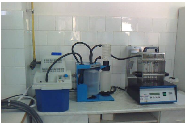
Sistem de mineralizare – distilare (determinare azot total)
