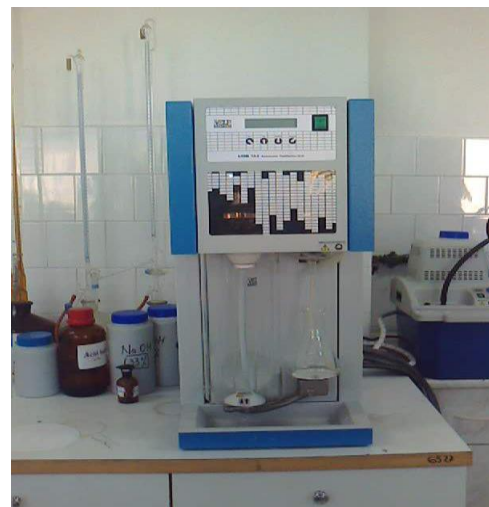
Sistem de mineralizare – distilare (determinare azot total)
