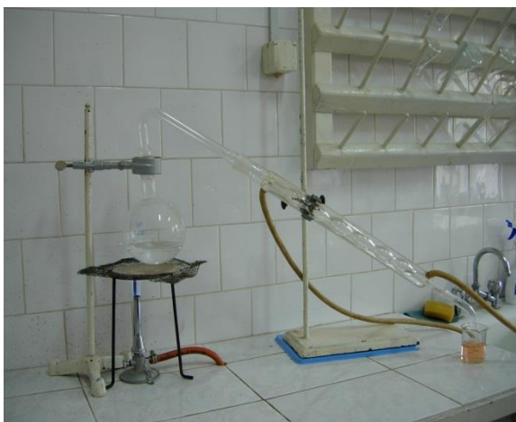
Instalație de distilare
