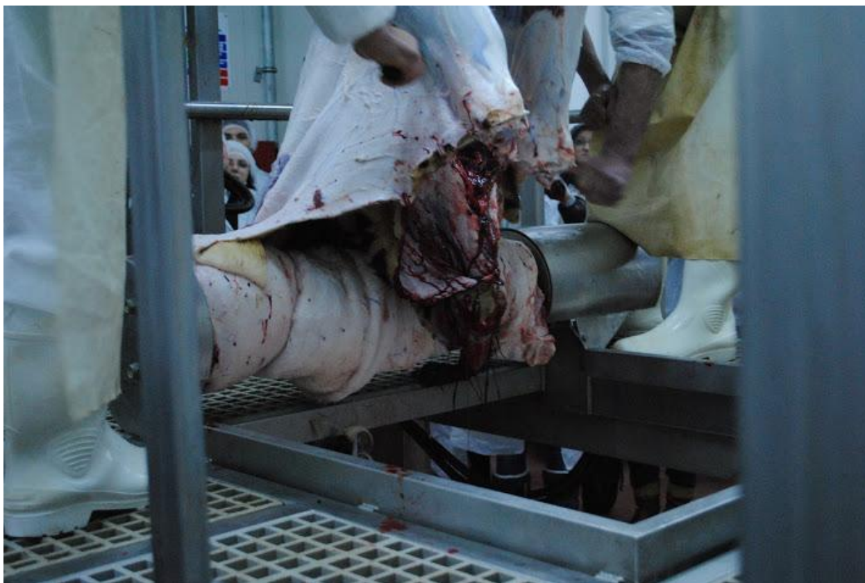
Figura 3.2. Jupuire mecanică. Sursa: poză făcută la abatorul Avastar, Roșcani
