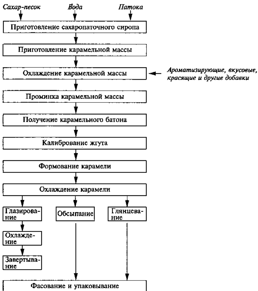
Рис. 17. Технологическая схема производства леденцовой карамели
