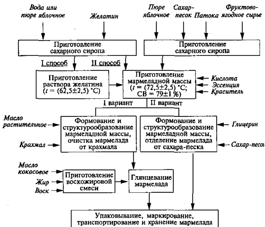
Рис. 45. Технологическая схема производства желеино-фруктового мармелада на желатине
