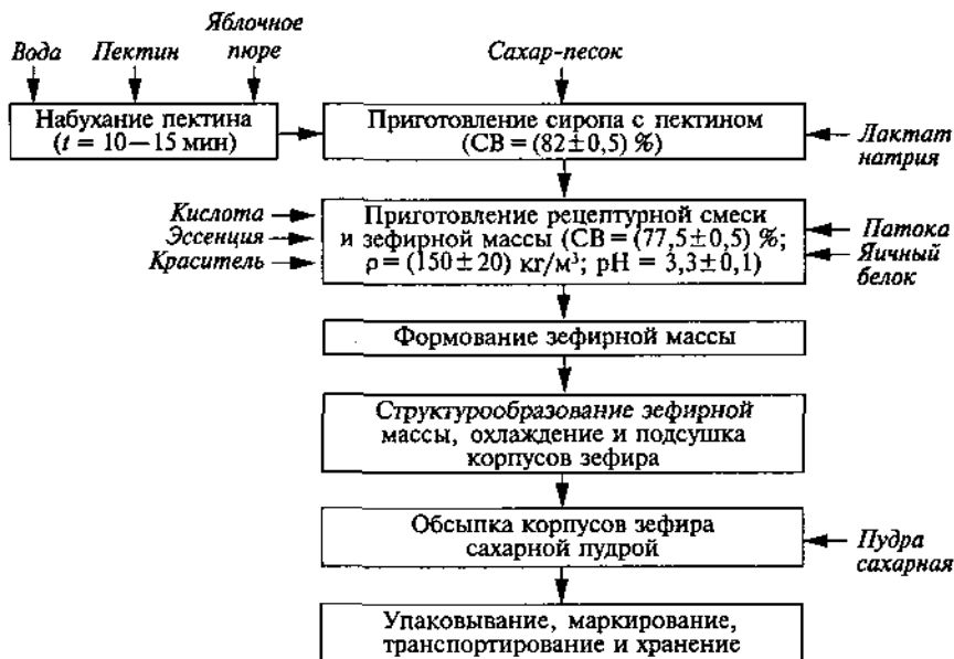
Рис. 51. Технологическая схема производства зефира на пектине поточно-механизированным способом
