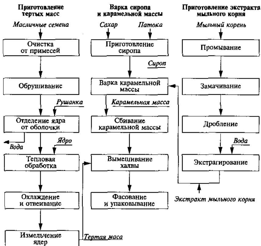
Рис. 58. Технологическая схема производства халвы
