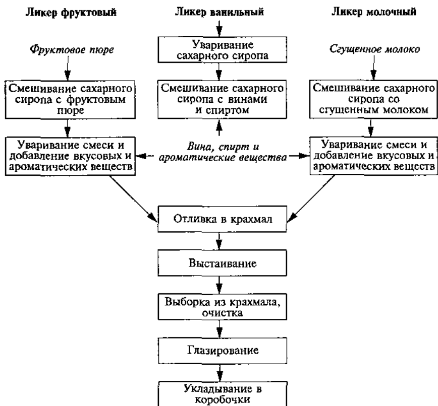
Рис. 30. Технологическая схема производства ликерных конфет
