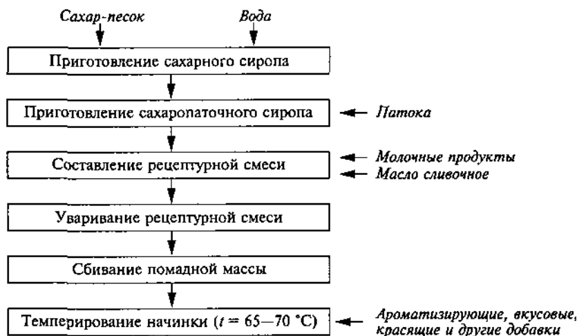
Рис. 10. Технологическая схема приготовления помадных начинок
