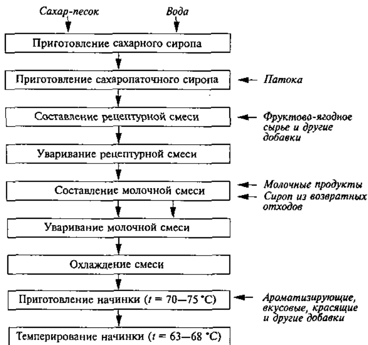
Рис. 11. Технологическая схема приготовления молочных начинок
